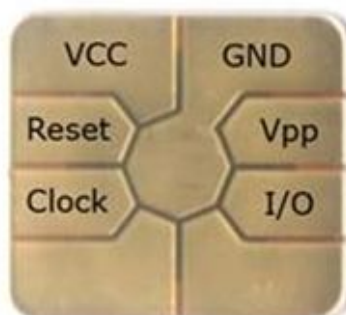
شکل ۲ - قسمت‌های مختلف کنتاکت‌های کارت هوشمند تماسی
